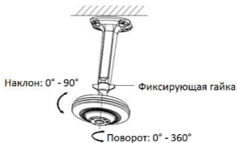
Рисунок 2-19 Настройка угла наблюдения
