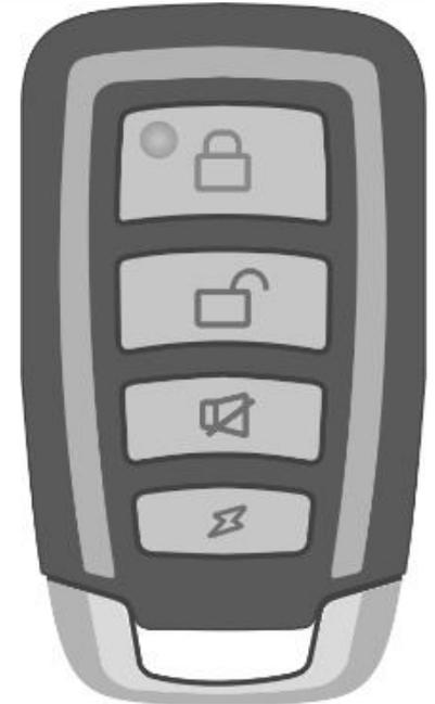
**Внимание!!!** Дальность действия брелка зависит от внешних условий и состояния элемента питания. В нормальных условиях дальность управления превышает 30 метров. Вблизи источников интенсивных электромагнитных излучений, например, недалеко от передающих телецентров, радиостанций, аэропортов, а также при разряде батареи питания брелка дальность управления может уменьшаться.
