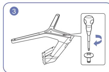
Полностью закрутите соединительный винт в нижней части подставки, чтобы как следует зафиксировать соединительный элемент.
