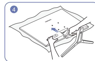
Постелите на стол мягкую ткань, а на нее экраном вниз положите устройство. Удерживайте заднюю часть устройства, как показано на рисунке. Вставьте собранную подставку в корпус в направлении стрелки, как показано на рисунке.
