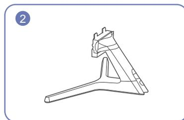
Проверьте, надежно ли закреплен соединительный элемент подставки.
