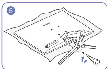
Закрутите винты в нижней части соединительного элемента.
