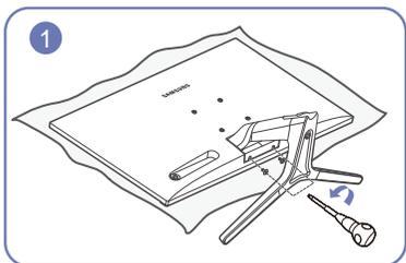
Постелите на стол мягкую ткань, а на нее экраном вниз положите устройство. Открутите винты в нижней части соединительного элемента.
