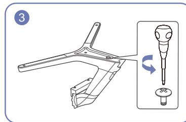
Открутите соединительный винт в нижней части подставки.
