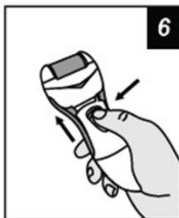
3. Нажмите кнопку разблокировки, расположенную по центру переключателя питания, и одновременно сдвиньте вверх переключатель питания, чтобы включить прибор.
