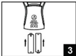
3. Установите в батарейный отсек две батареи типа AA с соблюдением полярности («+» к «+» и «-» к «-»).
