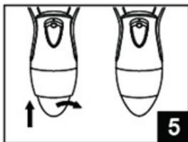
5. Поверните фиксатор крышки на 90 градусов вправо до щелчка. Убедитесь, что крышка надежно зафиксирована.
