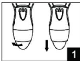
1. Выключите прибор переключателем питания. Поверните фиксатор крышки батарейного отсека влево на 90 градусов до щелчка.
